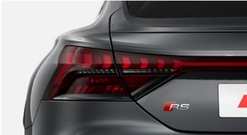
Die LED-Heckleuchten umfassen Blink-, Brems-, Schluss-, Rückfahr- und Heckkennzeichenleuchten in LED-Technologie. Ein entscheidender Vorteil der Bremsleuchten in LED-Technologie ist die schnellere Aktivierung, was zu einer früheren Wahrnehmung durch den nachfolgenden Verkehr führt.
